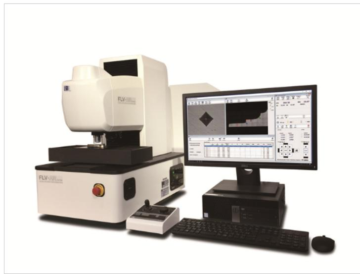
**显微硬度计测试要点：**显微硬度测量的准确程度与金相样品的表面质量有关，需经过磨光、抛光、浸蚀，以显示欲评定的组织。试样的表面状态：被评定试样的表面状态直接影响测试结果的可靠性。用机械方法制备的金相磨面，由于抛光时表层微量的范性变形，引起加工硬化，或者磨面表层由于形成氧化膜，因此所测得的显微硬度值较电解抛光磨面测得的显微硬度值高。试样好采用电解抛光，经适度浸蚀后立即测定显微硬度。选择正确的加载部位：压痕过分与晶界接近，或者延至晶界以外，那么测量结果会受到晶界或相邻第二相影响；如被测晶粒薄，压痕陷入下部晶粒，也将产生同样的影响。为了获得正确的显微硬度值，规定压痕位置距晶界至少一个压痕对角线长度，晶粒厚度至少10倍于压痕深度。为此，在选择测量对象时应取较大截面的晶粒，因为较小截面的晶粒其厚度有可能是较薄。
