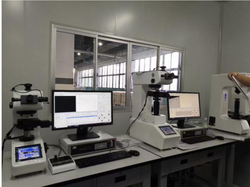
显微硬度计是反映材料弹性和塑性变形特性指标的重要机械性能指标。测定过程中样品制备简单，样品基本完好，接近无损检测，测量大小和形状不同的样品时，操作简单，测量速度快，硬度计和强度之间有相似的转换关系。根据经度值，可以得到大致的强度限制。测试是指使用标准形状和大小的相对坚硬的物体，在特定压力下接触材料表面，确定材料在变形过程中的抵抗力，称为显微硬度计测试。通过施加不同载荷的方法获得的显微硬度计是材料抵抗塑性变形的能力，显微硬度计是材料抵抗弹性变形的能力。当负荷大于1公斤的测试力时，我们称之为显微硬度计，主要用于大样品，希望测试能反映材料的宏观性能。负载小于1公斤的实验力称为显微显微硬度计，主要用于小而薄的样品，希望反映小范围的材料特性，如相结构的显微显微硬度计和表面显微硬度计。显微硬度计阻力越大，硬度越高，相反，硬度越低。扬州齿轮渗碳淬火显微硬度计厂家
