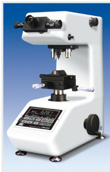
显微硬度计试验负荷：为保证测量的准确度，试验负荷在原则上应尽可能大，且压痕大小必须与晶粒大小成一定比例。特别在测定软基体上硬质点的硬度时，被测质点截面直径必须四倍于压痕对角线长，否则硬质点可能被压通，使基体性能影响测量数据。此外在测定脆性质点时，高负荷可能出现“压碎”现象。角上有裂纹的压痕表明负荷已超出材料的断裂强度，因而获得的硬度值是错误的，这时需调整负荷重新测量。显微硬度计压痕的弹性回复：对金刚石压头施一定负荷的力压入材料表面，表面将留下一个压痕，当负荷去除后，压痕将因金属的弹性回复而稍微缩小。弹性回复是金属的一种性质，它与金属的种类有关，而与产生压痕的荷重无关。就是说不管荷重如何，压痕大小如何，弹性回复几乎是一个定值。因此，当荷重小时，压痕很小，而压痕因弹性回复而收缩的比例就比较大，根据回复后压痕尺寸求得的显微硬度值则比较高。这种现象的存在，使得不同荷重下测得的硬度值缺乏正确的比较标准，因此有必要建立显微硬度值的比较标准。扬州齿轮渗碳淬火显微硬度计厂家显微硬度计同时可在极小范围内进行多点测试。
